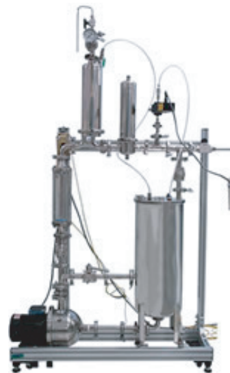
(参考2) ポンプ圧送方式濾過装置
