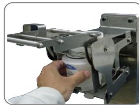
③ 세트 레버를 안전 정지 장치가 작동하는 위치까지 내려서 세팅 완료 (안전 정지 장치 기능에 의해 세트 레버의 돌출 방지)
